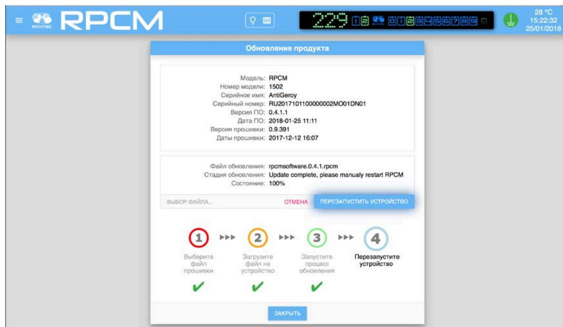
Рисунок 4.7.9. Окно с активной кнопкой для перезапуска контроллера.
