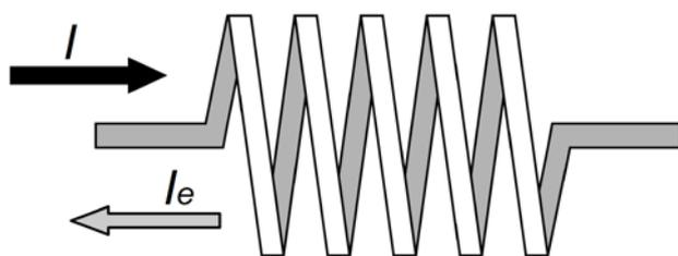
Рисунок 5.9.7. Направление тока питания и тока самоиндукции в катушке индуктивности.
