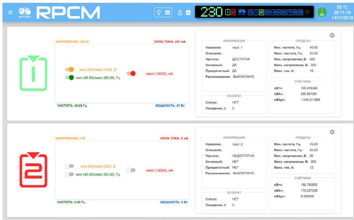
Рисунок 4.4.11. Установка демонстрации лимитов на примере RPCM 1502 и RPCM 1532. Для первого ввода включен режим демонстрации.
