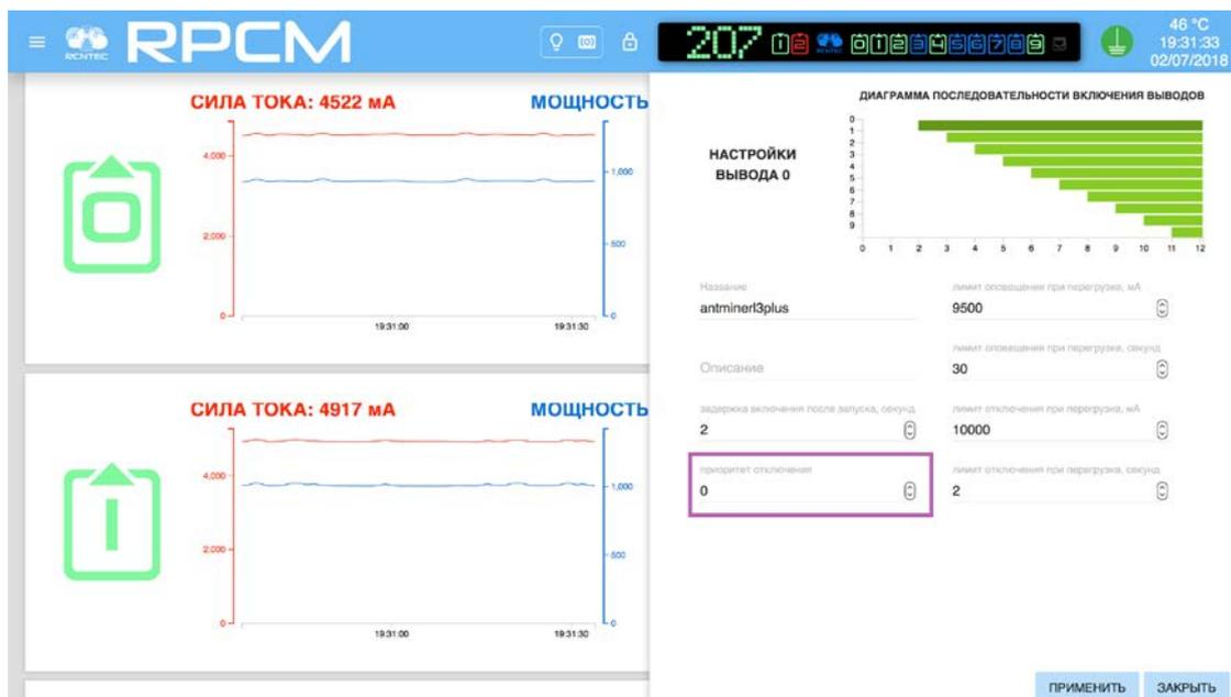
Рисунок 5.3.2. Настройка параметров для выводов. Пурпурным цветом отмечено значение "приоритет отключения".
