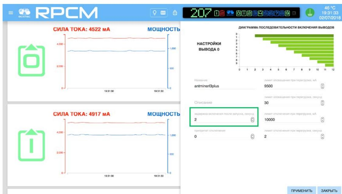
Рисунок 5.3.1. Настройка параметров для выводов. Темно-зеленым цветом отмечено значение *turn on delay* для текущего вывода "9".
